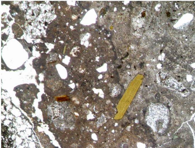
Próbka 2E ( zaprawa wapienna z filara piwnicy Wielkiej Zbrojowni w Gdańsku, zaprawa o właściwościach hydraulicznych).
