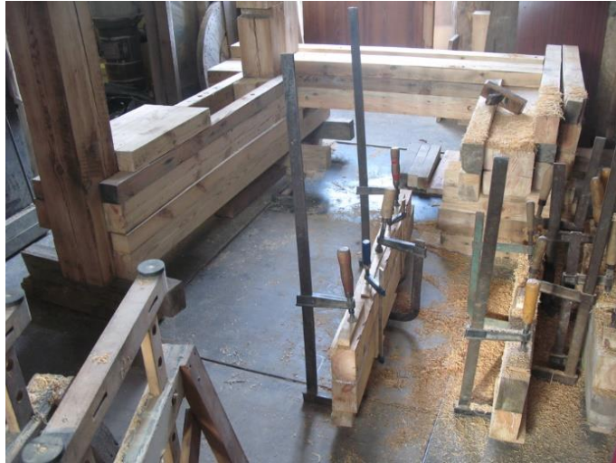
9. Proces klejenia warstw i budowania masy rzeźby
