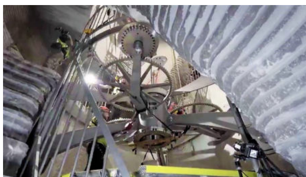
Mechanizm zegara umieszczony w wykutej skale 114 .
