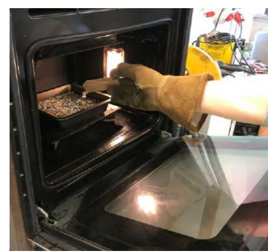
Na zdjęciach po lewej (fot. 52) rozdrabniacz do tworzyw, po prawej (fot. 53) pierwsza prasa z zaadaptowanego do tego celu piekarnika fot. autora
