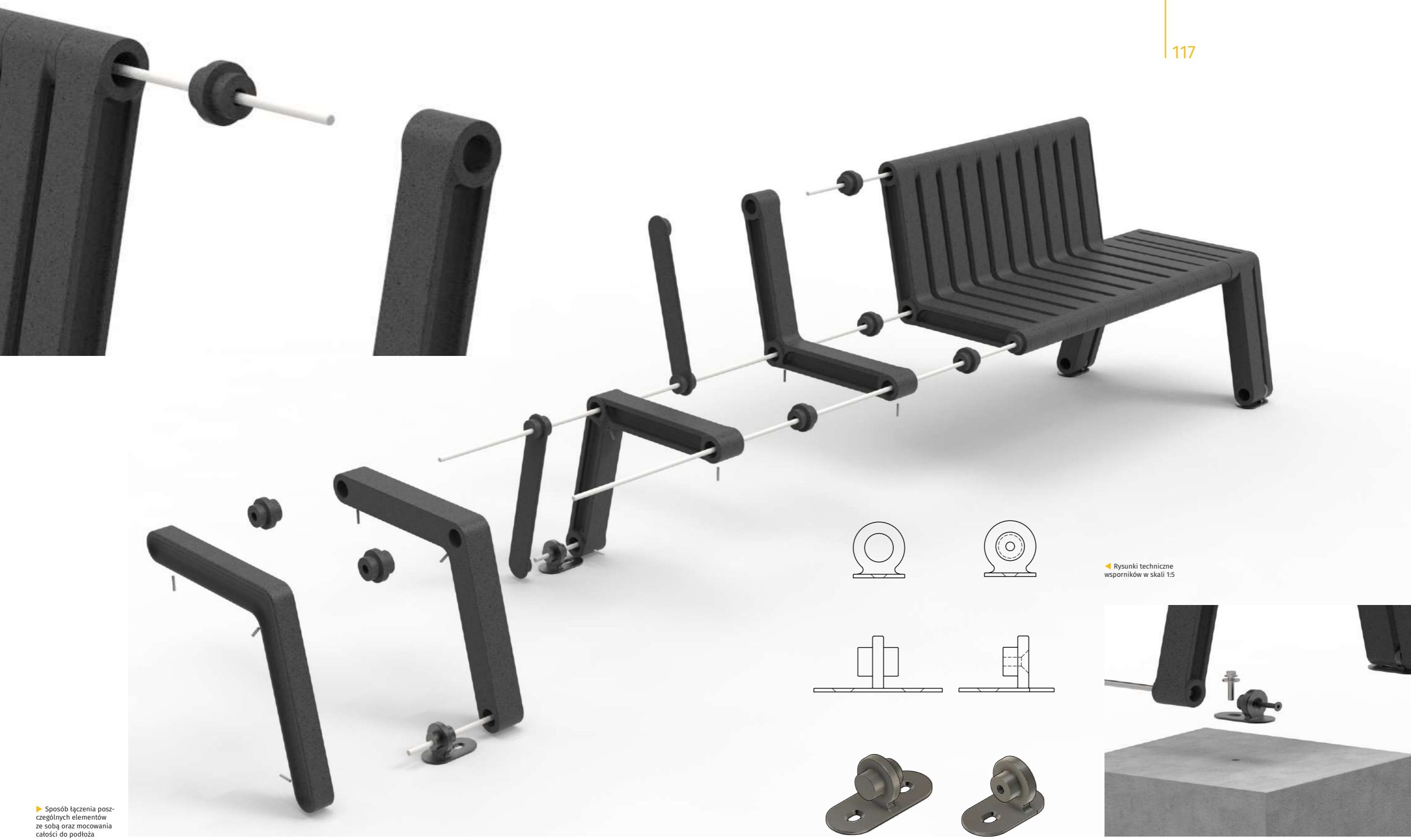
◀ Sposób mocowania mebla i kotwienia wspornika do podłoża – standardowa kotwa ze śrubą oraz uniwersalny wspornik
