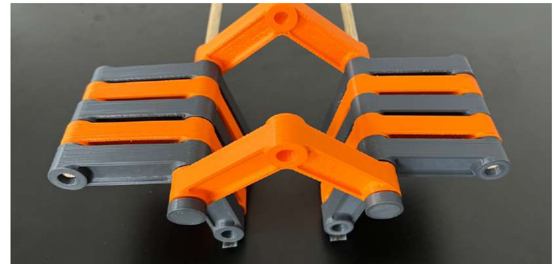
◄ Modele wydrukowane z PLA na drukarce 3D FDM w skali 1:5.
