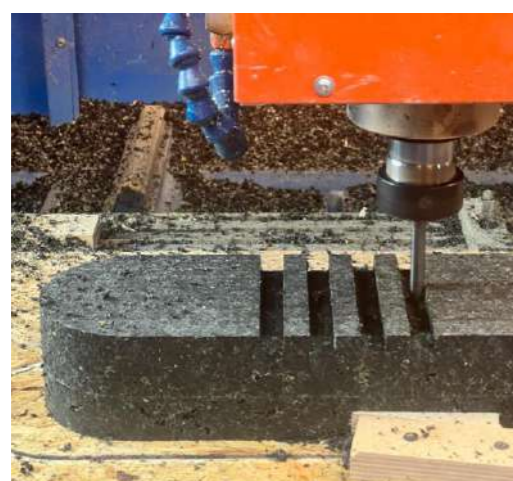
▶ Na zdjęciach obok (fot. 62–63) widoczna obróbka skrawaniem CNC projektu Rubber Bumper wykonanego z mieszanki HDPE z recyklatem opon samochodowych w proporcji 1:1 fot. autora
