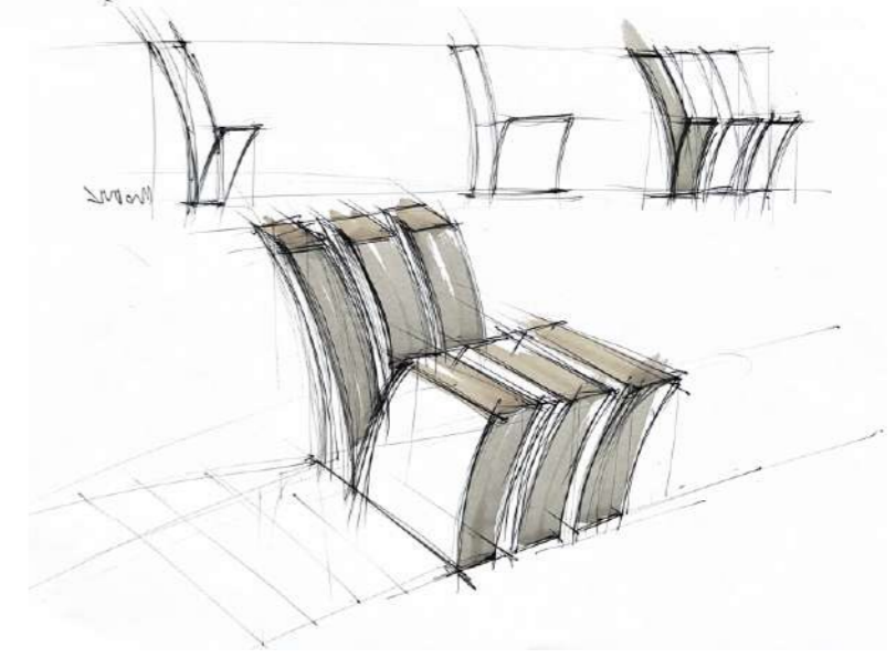
Szkic nr 11 to koncepcja siedziska bazująca na jednym module, o przeciwstawnych sobie częściach siedziska i oparcia, forma nawiązuje do motywu roślinnego, ale formowanie płyt z takiej masy recyklatów wydaje się nieuzasadnione ekonomicznie.
