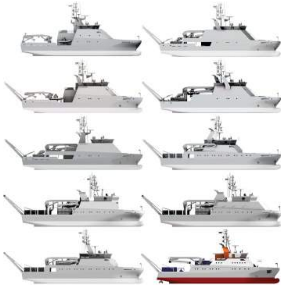
Il. 69 Widoki sylwet ilustrujące manipulacje w zakresie zmian proporcji bryły jednostki.
