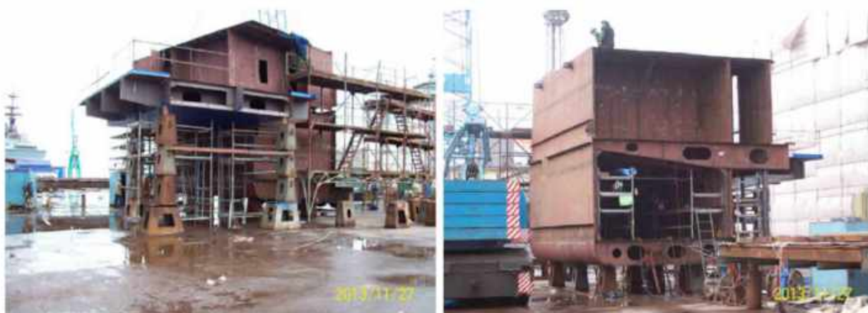
Budowa centralnych sekcji kadłuba statku. il. Stocznia Remontowa Nauta S.A.
