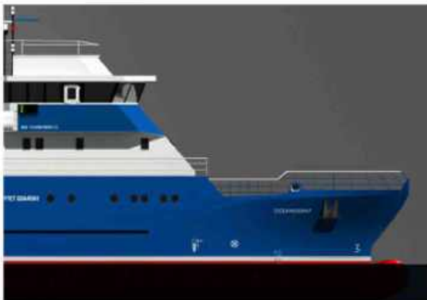
Wybrane fragmenty studium korekty dziobowych nadburci prezentujące różne rozpatrywane warianty geometrii cięcia oraz detali. il. Autor
