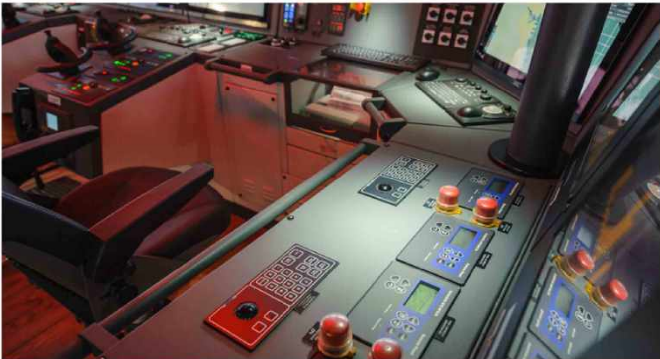
Fragment pulpitu: detal pochwytywów, wykończenia miejsca przenikania pilersu z panelem elewacyjnym. Dobrze widoczna jest także wysoka jakość wykonania i montażu (Famor SA), fot. Dariusz Dyr
