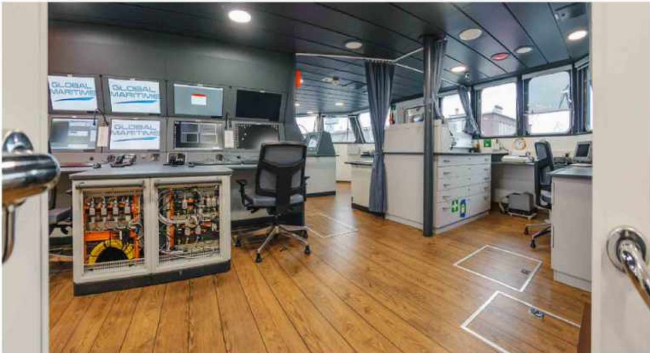
Sterówka. Widok z klatki schodowej. Widoczne otwarte szafy RACK z wyposażeniem naukowo-badawczym. Po prawej stronie stanowisko GMDSS. W głębi przejście do nawigacyjnej strefy pomieszczenia. fot. Dariusz Dyr
