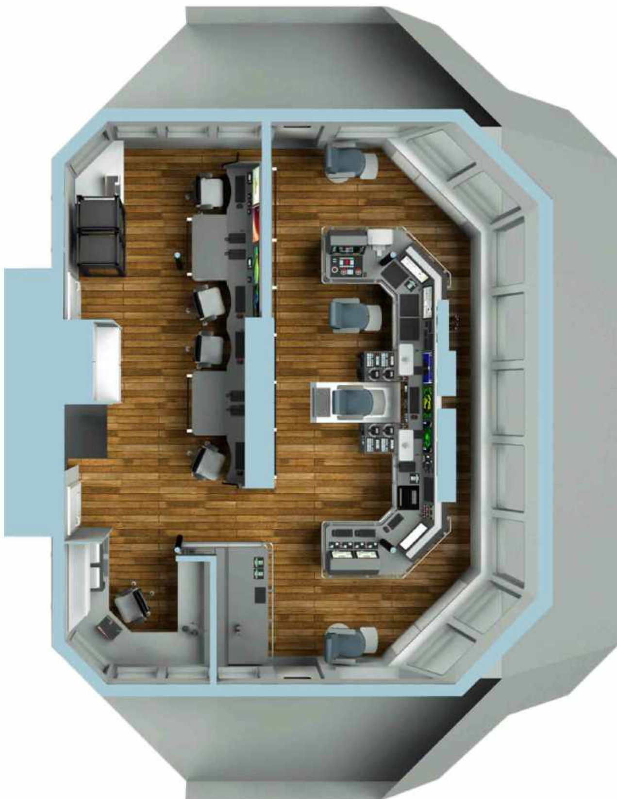
Szczegółowy model 3d koordynujący całą sterówkę - produkt il. Autor
