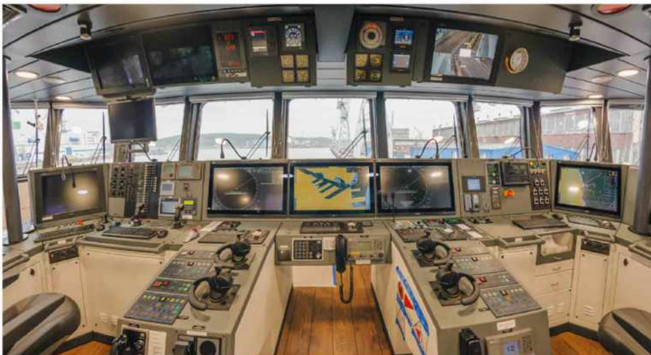
Centralna część pulpitu manewrowo-nawigacyjnego, widziana „okiem sternika”. fot. Dariusz Dyr
