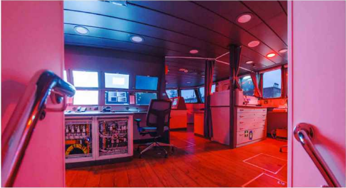
Sterówka z włączonym oświetleniem nocnym. Widok z klatki schodowej. Widoczne otwarte szafy z wyposażeniem naukowo-badawczym. Po prawej stronie stanowisko GMDSS. il. fot. Dariusz Dyr
