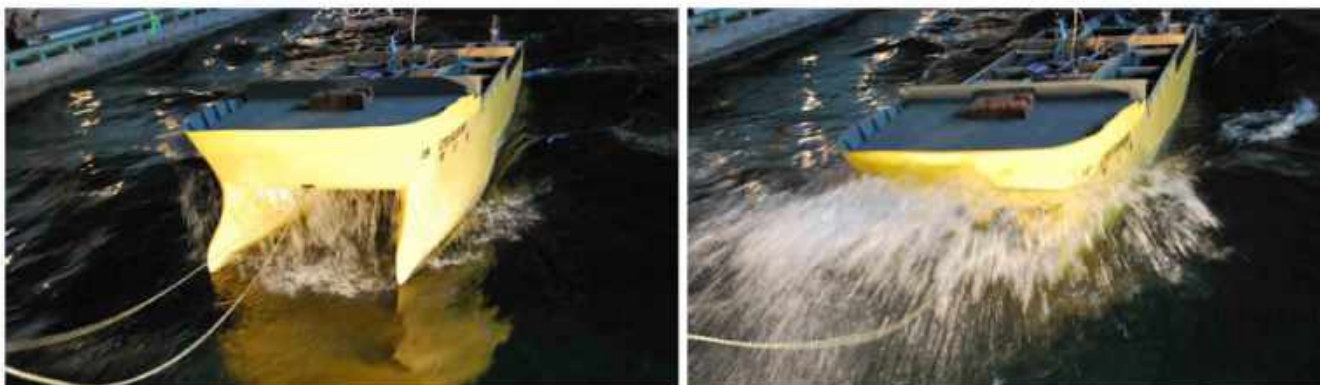
Przykład niekorzystnego zachowania kadłuba 48-metrowej wersji statku. il. CTO
