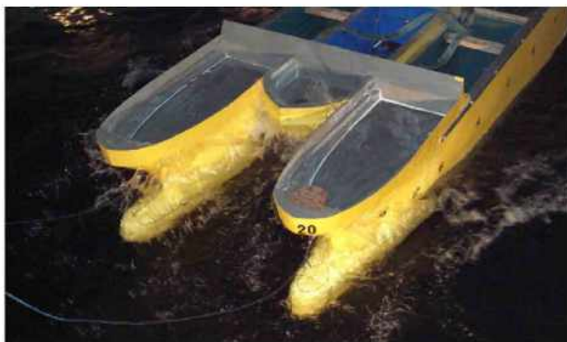
Model testowy na basenie modelowym. il. CTO
